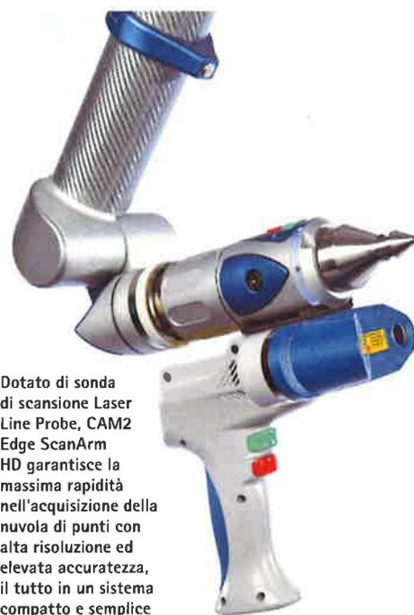
Dotato di sonda di scansione Laser Line Probe, CAM2 Edge ScanArm HD garantisce la massima rapidità nell'acquisizione della nuvola di punti con alta risoluzione ed elevata accuratezza, il tutto in un sistema compatto e semplice da usare.
